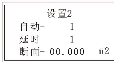
显示屏中，自动为“0”符号表示自动测量，设置为“0”为自动测量，若需手动测量，应将该符号置为“1”。
